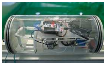
O MarinEye contém dois cilindros com vários filtros que capturam micro-organismos para análise de ADN, sem alterar as condições ambientais em que vivem. Cada mililitro de água do mar pode conter 100 mil micro-organismos
