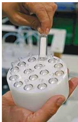
O MarinEye contém dois cilindros com vários filtros que capturam micro-organismos para análise de ADN, sem alterar as condições ambientais em que vivem. Cada mililitro de água do mar pode conter 100 mil micro-organismos
